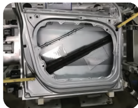
แผ่นแดมป์ลดเสียงและลดการสั่นสะเทือน Butyl Damping Plate
